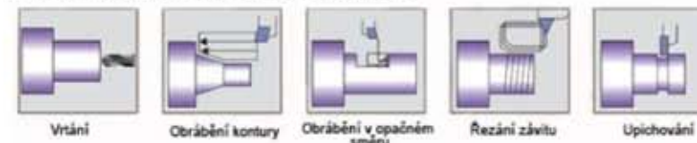
Příklad vestavěných cyklů pro hrotové soustruhy
